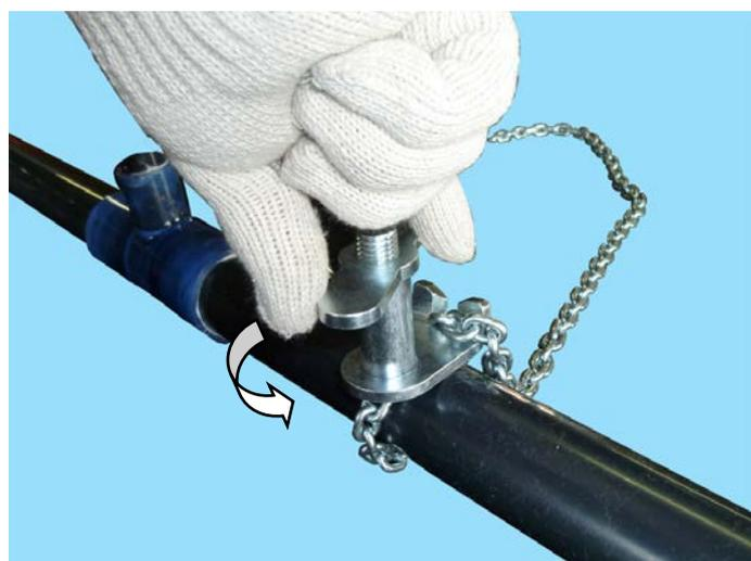
⑤ 両側のナットプレートを緩めて、パイプから締め具を取り外します。
