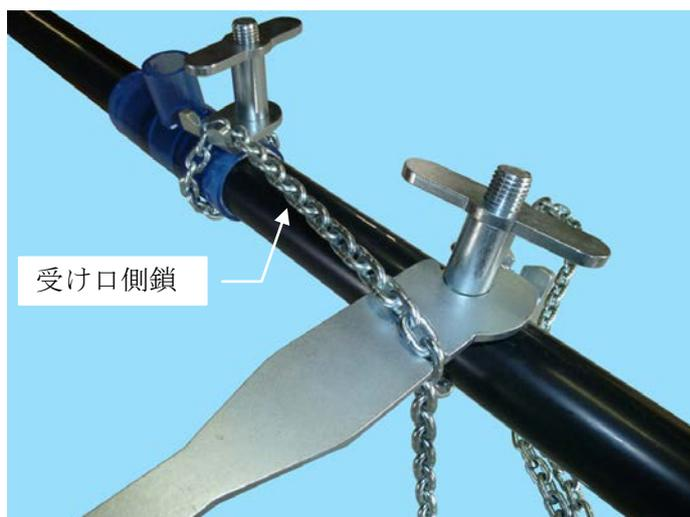
④ 挿し口側の締め具にテコハンドルを掛け、テコハンドルの鎖掛け口に受け口側の鎖を掛けて、テコハンドルを作用してパイプを引き込みます。
