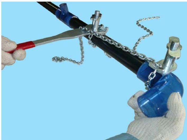
※ Lボや短管等の挿入は受け口と挿し口が平行に入るように片手で保持してください。
